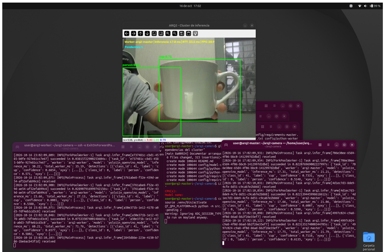
Figura 5. Detecciones de taza y persona y registros de ejecución de los workers remoto y local. Fuente: elaboración propia.
